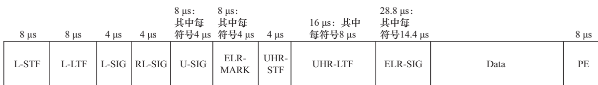
图4 UHR ELR PPDU 帧格式
